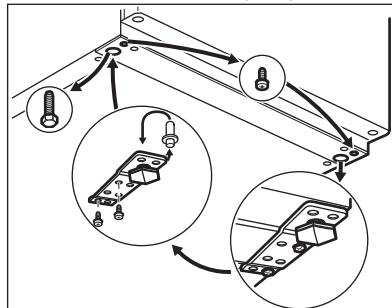
5. Вывинтите винт и установите его на противоположной стороне.
