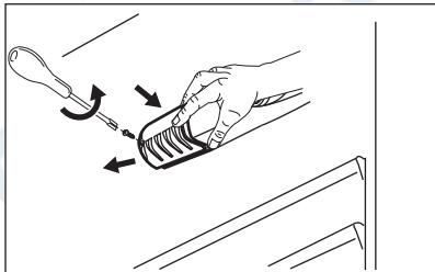
3. Замените использованную лампу новой лампой такой же мощности и предназначеннной специально для бытовых приборов (максимальная мощность указана на плафоне).
